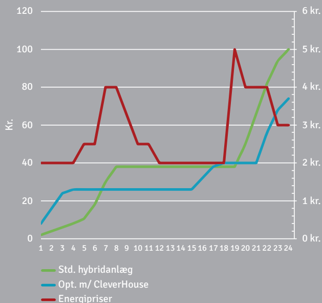
Figur 1: En simulering på en forbrugers dagsforbrug på 90kWh og som har et solcelleanlæg, der på den givne dag producerer 60kWh.
